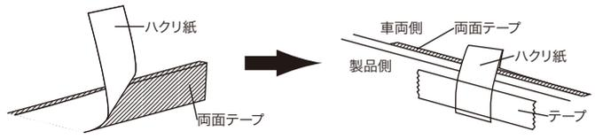
ハクリ紙を剥がした部分のみで、位置決め調整しつつ、圧着せず初期固定します。
