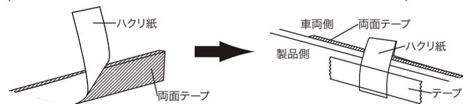
ハクリ紙を剥がした部分のみで、位置決め調整しつつ、圧着せず初期固定します。最終取付け位置が決まりましたら、ハクリ紙のツマミを車両と製品の隙間から、ゆっくり抜き出して下さい。(ツマミを一気に抜き出すと、途中で切れますので注意して下さい。)
